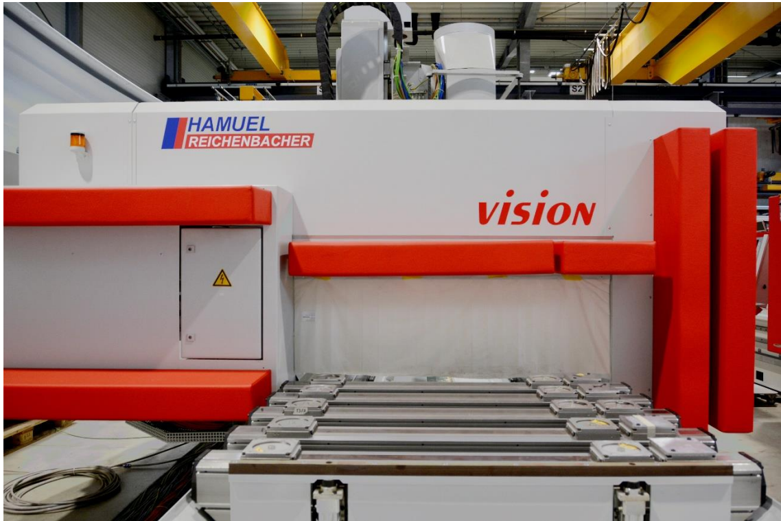
Auf dem Maschinenbett sind 10 Werkstückkonsolen montiert, die Verstellung erfolgt elektromotorisch.
