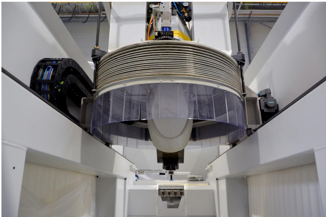
Kardanischer Arbeitskopf mit automatischem Werkzeugwechsler und 24 kW Frässpindel, 20° unterschwenkend.
