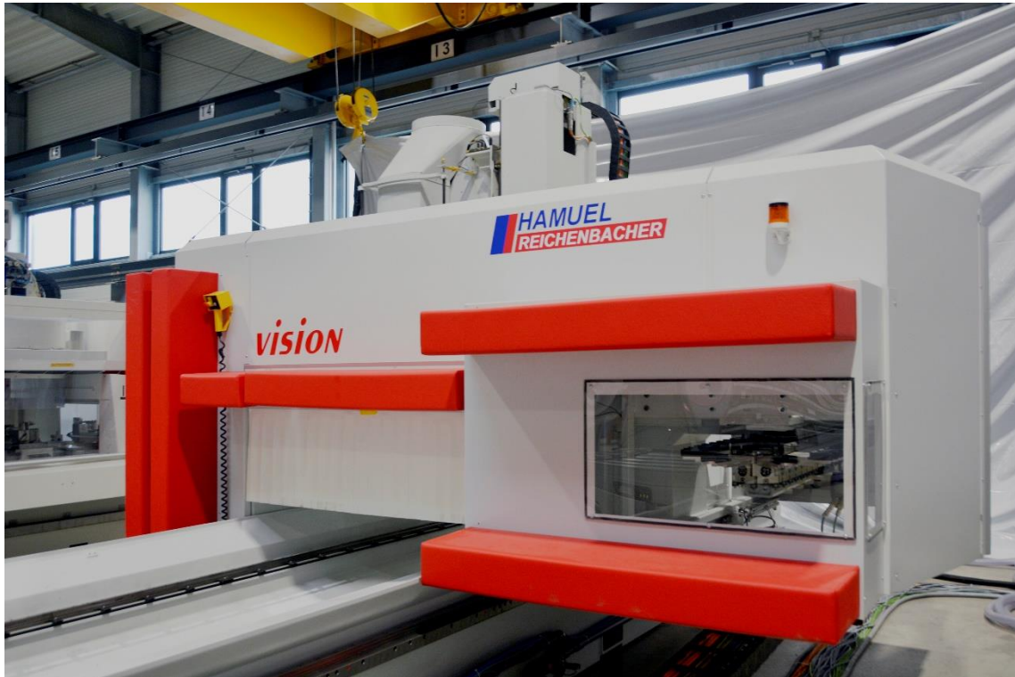
Stellfläche ca. 12,0 x 4,5 m. Tragbares Handbediengerät mit 3,5 m Verbindungskabel.
