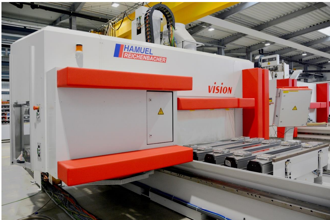
Freie Höhe zwischen Oberkante / Grundkörper und Portalunterkante ca. 400 mm.
