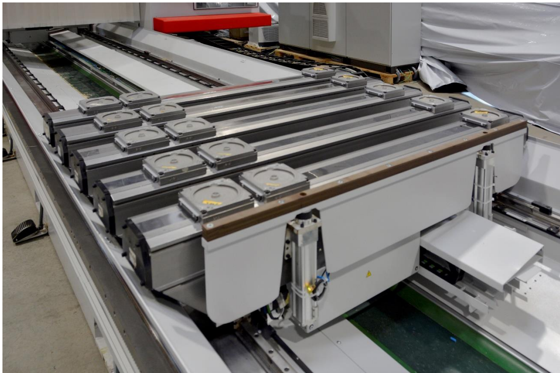
Auf der Oberseite der Konsolen sind 3 Grundkörper angeordnet, die Verstellung erfolgt elektromotorisch.
