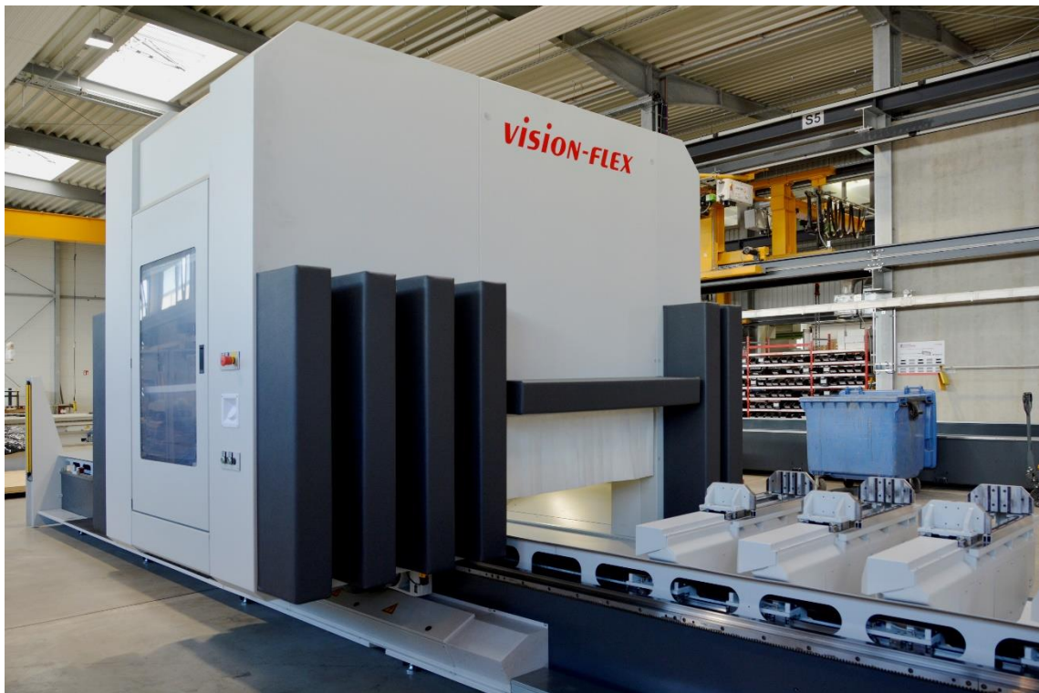
Durch das Absolut-Wege-System der CNC-Achsen ist keine Referenzfahrt nötig.
