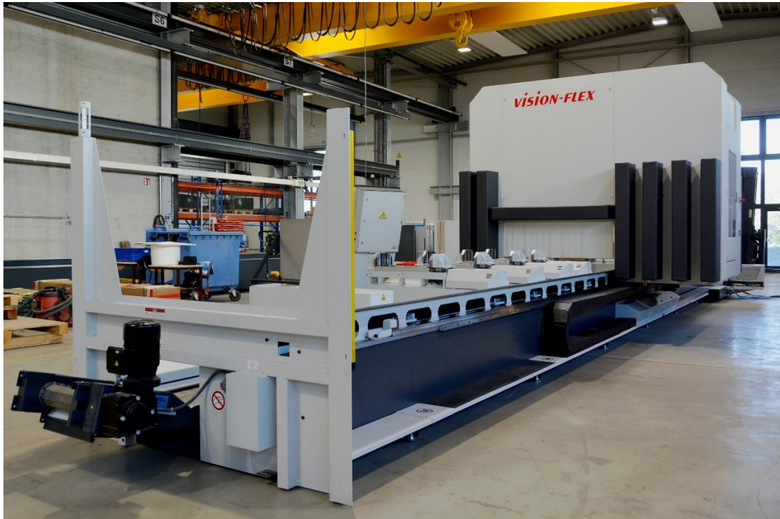
Arbeitsbereiche bei einfacher Beschickung: max. 7.300 x 500 mm, Drei-Seiten- und Vor-Kopf-Bearbeitung.
