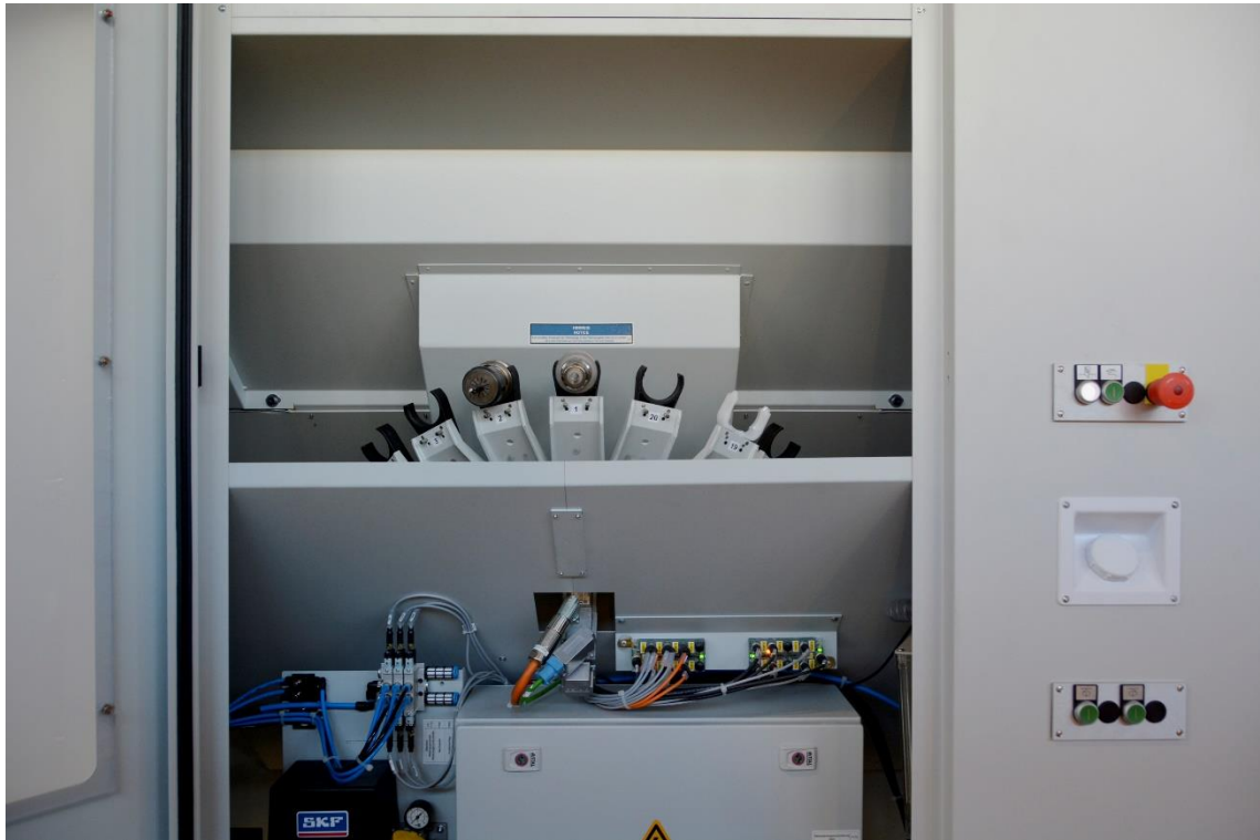
Automatischer Tellerwechsler für 20 Werkzeuge, an der Portalrückseite angebracht, fährt in der Längsachse mit.
