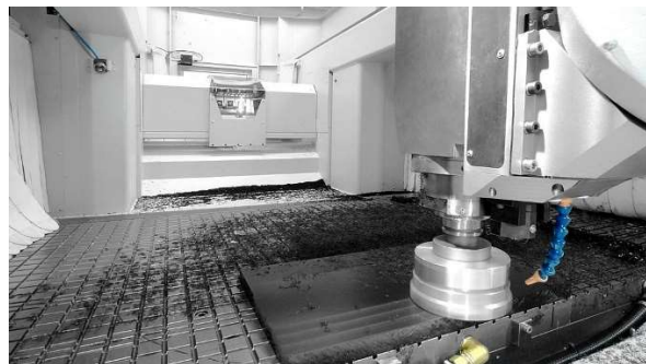
Es ist wichtig, spezielle Werkzeuge für die Kunststoffbearbeitung zu verwenden, die eine hohe Verschleißfestigkeit bieten, die auch zur Feinbearbeitung und Oberflächenveredelung geeignet sind. (Foto: Reichenbacher Hamuel)
