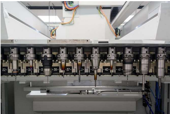
Die CNC-Anlage verfügt über einen automatischen Kettenwechsler für 81 spezielle Werkzeuge. (Foto: Reichenbacher Hamuel)
