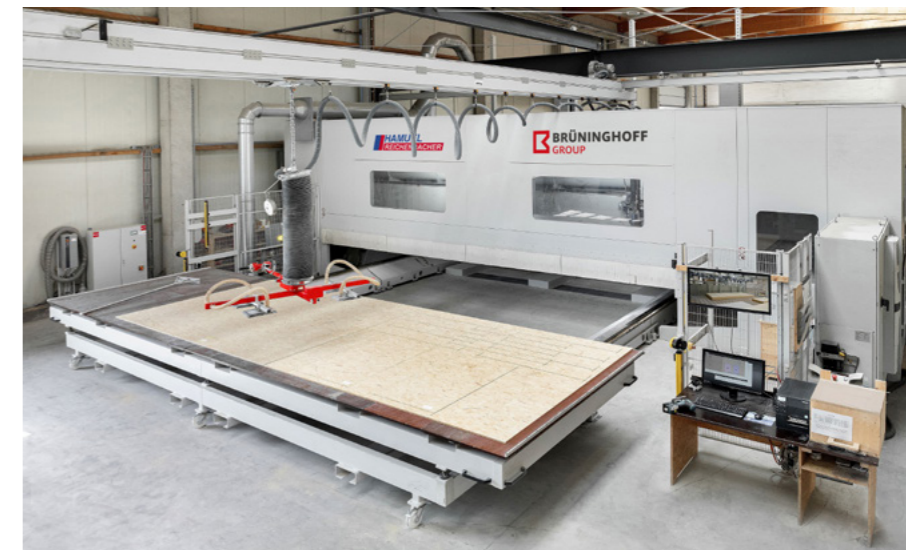
Die Brüninghoff Group setzt bei der Bearbeitung großer Platten auf eine massive Standportalanlage des Typs Eco 8126-A von Reichenbacher Hamuel.
