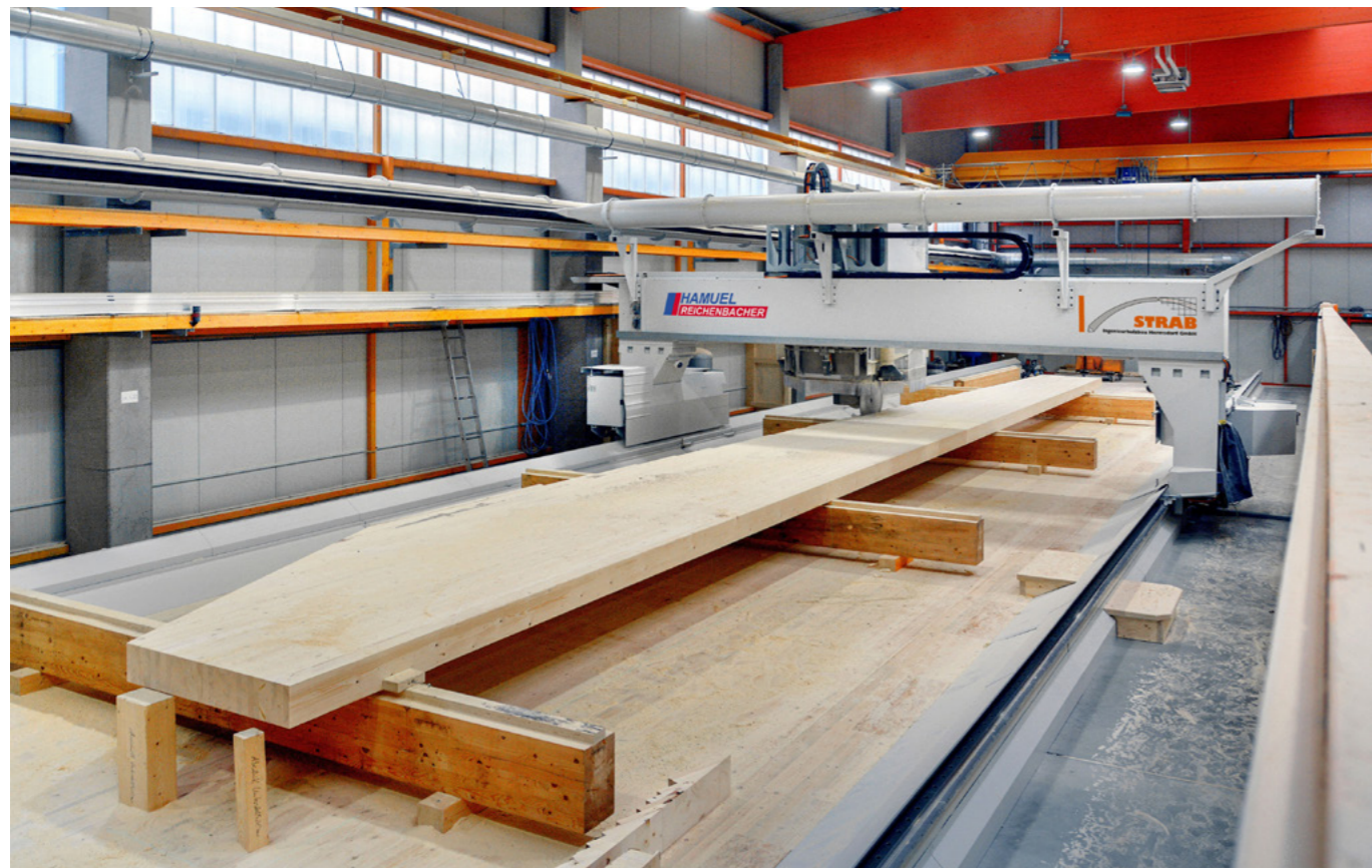
Strab Ingenieurholzbau bearbeitet große BSH-Elemente auf einer Fünffachs-CNC-Anlage von Reichenbacher Hamuel.
