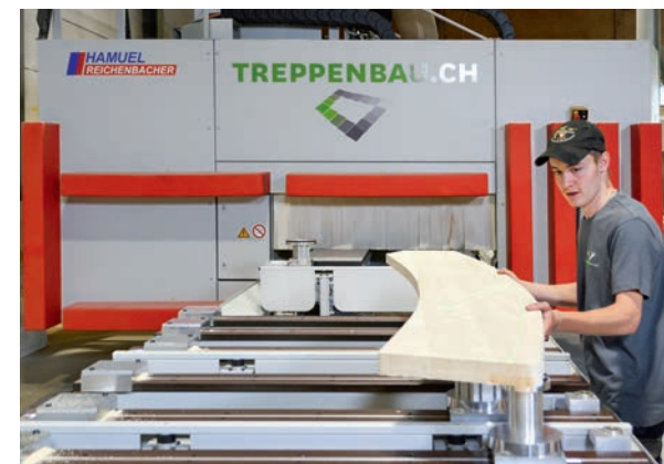
► Technisch besonders: die LED-Positionierung. Der Maschinenbediener verschiebt das Werkstück manuell per LED.
