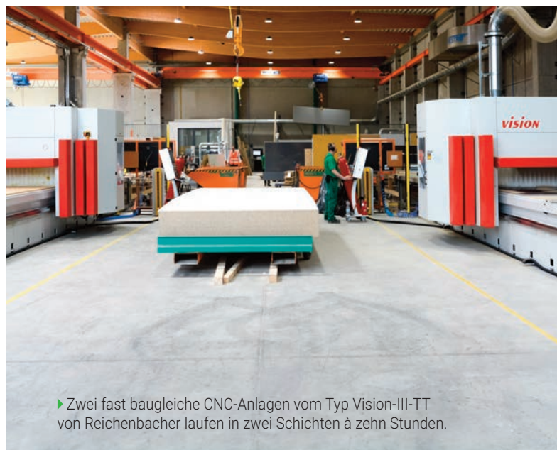
► Auf einer Vision-III-TT können Platten bis zu 6.000x2.500mm in fünf Achsen bearbeitet werden.
