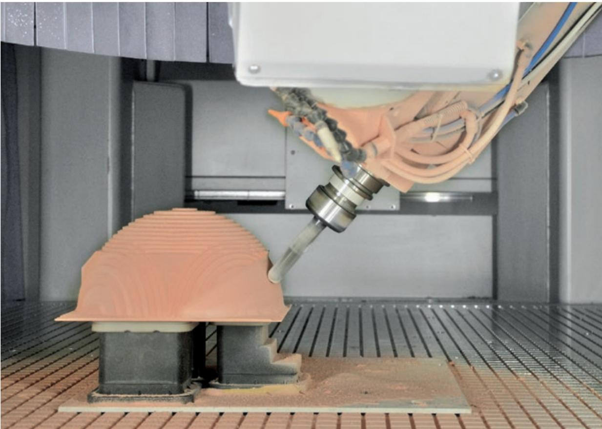
Die Bauteile können mit dieser Anlage aufgrund der 5-Achs-Technologie in nur einer Aufspannung komplett und hochpräzise bearbeitet werden Foto: Reichenbacher
