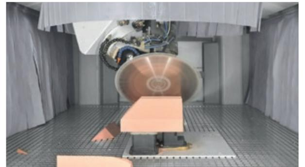
5-Achs-Bearbeitung eines Ureol-Blocks mit Sägeblatt mit 400 mm Durchmesser Foto: Reichenbacher
