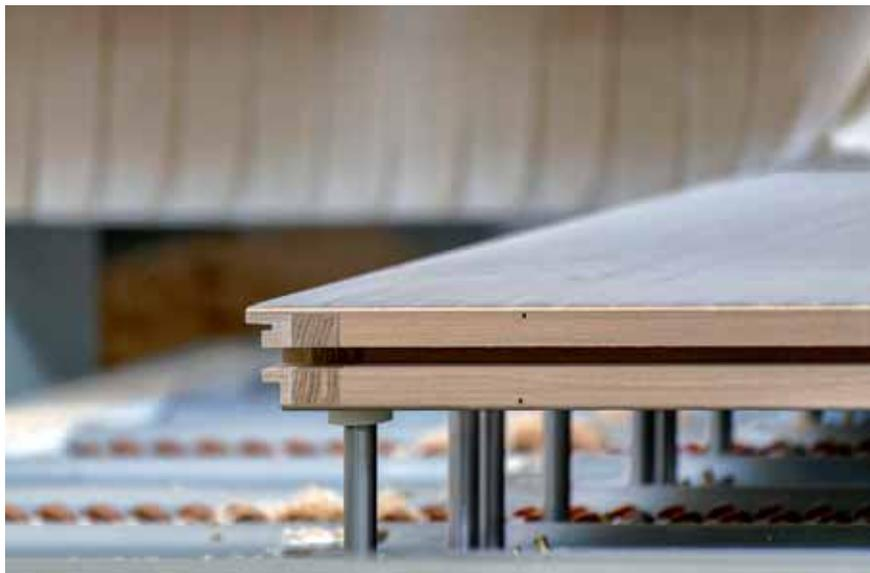
**Rollenbahn im Maschinenbett des BAZ: ausgefahrene Pins mit aufgespanntem Türblatt**
