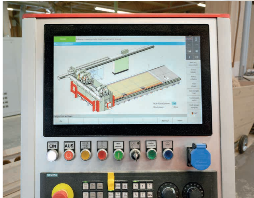
Umfangreiche Grundprogrammierung von NC-HOPS durch Softwarehersteller direkt cnc-systeme. Mit Zusatzmodul betterNEST können Rohteile je nach Faserverlauf und Qualität ineinander genestet werden.
