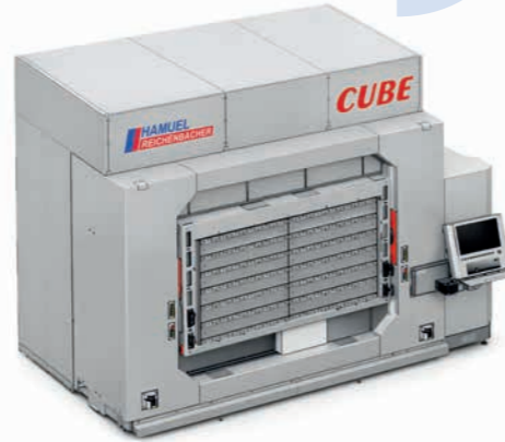
Arbeitsraum 2.300 x 1.600 x 500 mm bei einer Grund- fläche von 5.000 x 2.500 mm.
