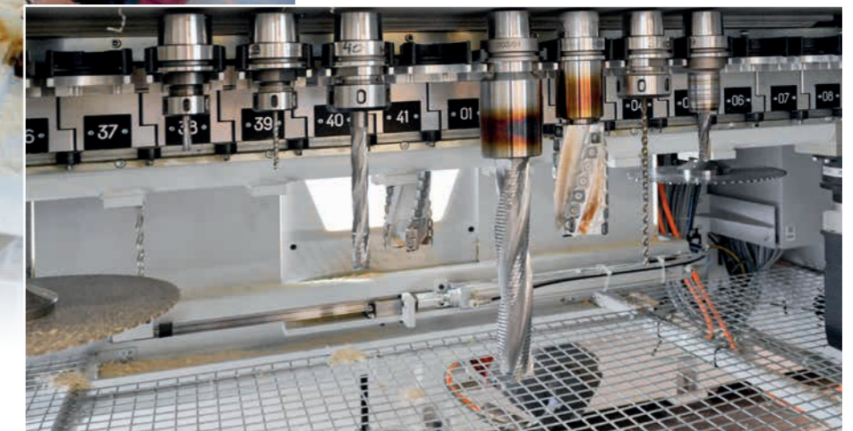
Der Werkzeugwechsler (41-fach) bietet Platz für eine Vielzahl von Fräsern, Bohrern und schweren Werkzeugen.
