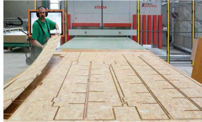
Auf der 5-Achs-Anlage mit Nestingfunktion kann Schalungsplattenmaterial in Maßen bis zu 6.000 x 2.500 mm bearbeitet werden.
