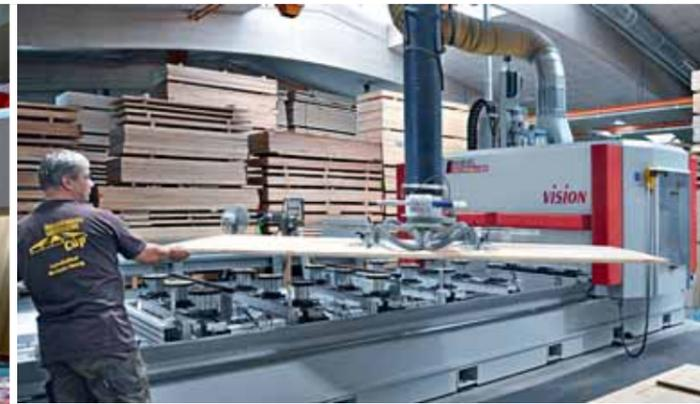
Unten: Bei Bühnenbau Wertheim ist man mit den Ergebnissen der „Vision-II-Sprint“ von Reichenbacher sehr zufrieden. Links: Das CNC-Bearbeitungszentrum bildet zusammen mit einem Vakuum-Schlauchheber von J. Schmalz ein perfektes Duo
