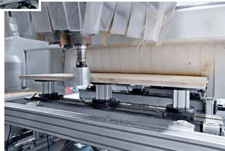
Im Bühnenbau kommen schwere Werkstoffe zum Einsatz. Für die Bearbeitung der 180-Kilogramm-Platten ist ein solides Maschinenbett unabdingbar
